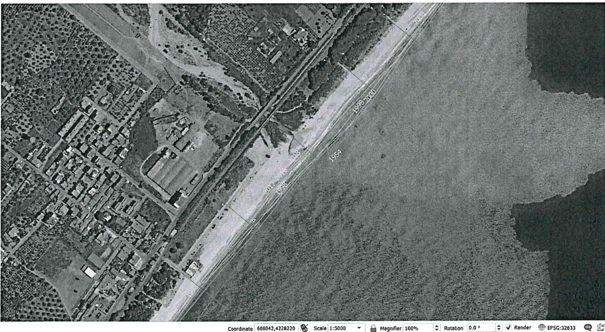
Fig. 14 – Transetti (in rosso) e tutte le linee di riva estratte e tracciate. Sfondo: immagine satellitare di Google. Software utilizzato: QGIS 3.10.7.
